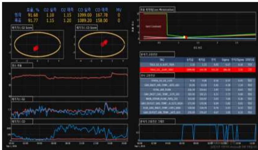
그림 13. 연소효율 최적화 시스템의 HMI 예시
